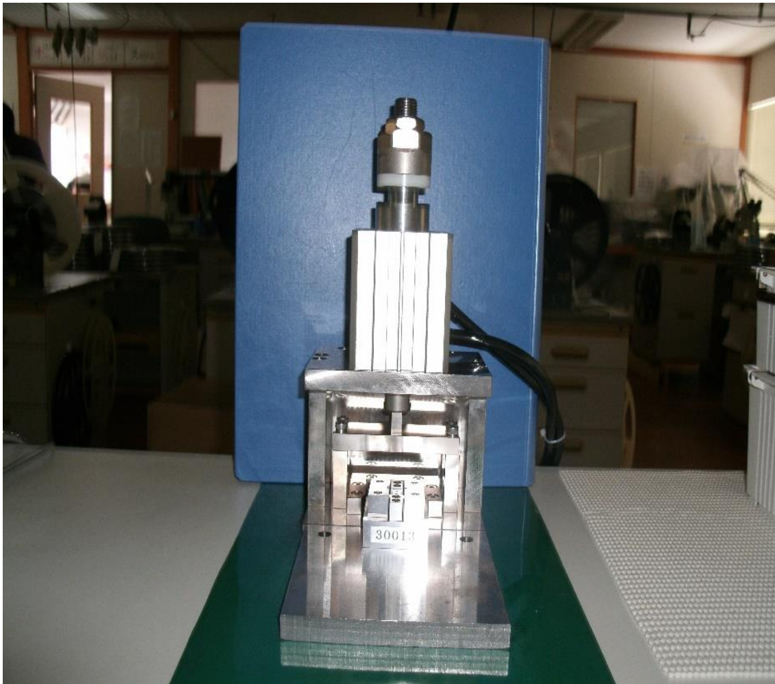
【 端子圧入治具 】 (弊社設計治具)
